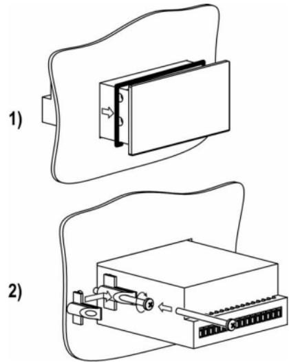
Рисунок 4.3 – Монтаж прибора щитового крепления
