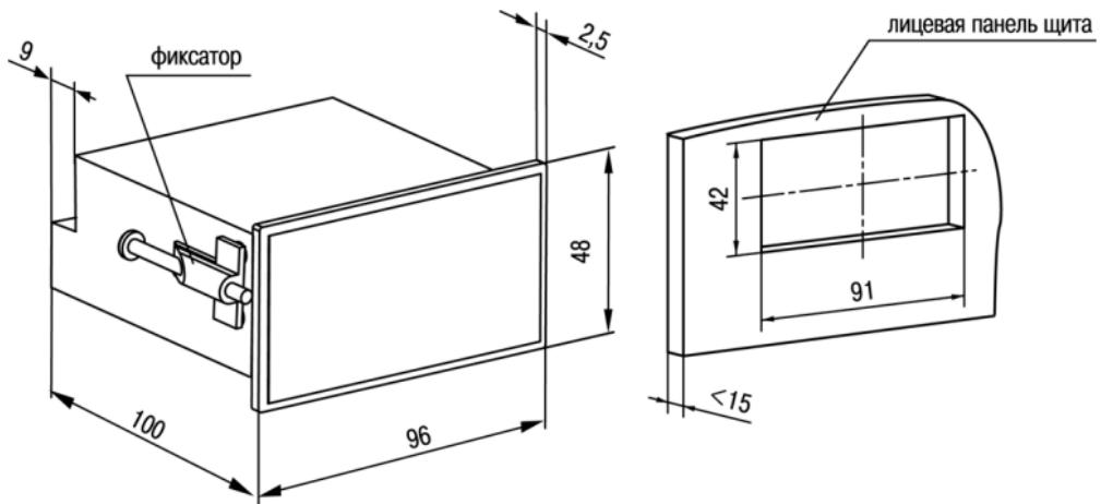
Рисунок 4.4 – Габаритные размеры корпуса Щ2
