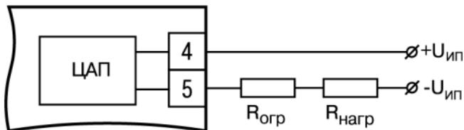
Рисунок 5.4 – Схема подключения ВУ типа И
