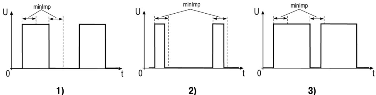
Рисунок 6.4 – Работа параметра  $\text{minImp}$
