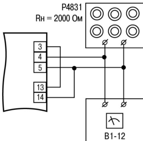
Рисунок 8.1 – Юстировка значений выходного напряжения
