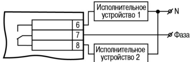
Рисунок 5.6 – Схема подключения нагрузки к ВУ типа Р
