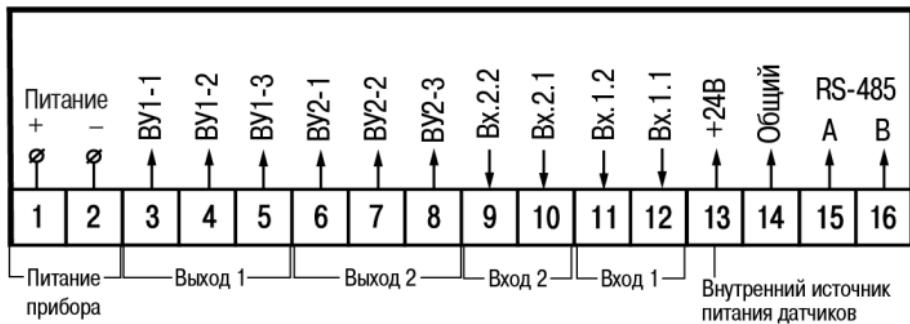
**Рисунок 5.1 – Назначение контактов клеммника**
