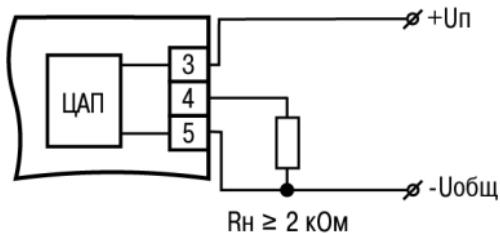
Рисунок 5.5 – Схема подключения ВУ типа У
